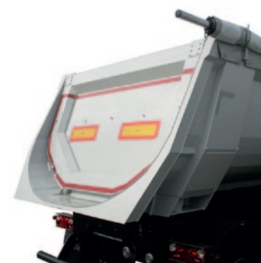
Sprawne elementy blokujące tylną klapę
