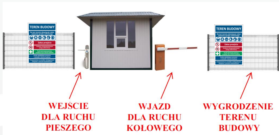
Rys. 1 Wejście/wyjście oraz wjazd na teren budowy
