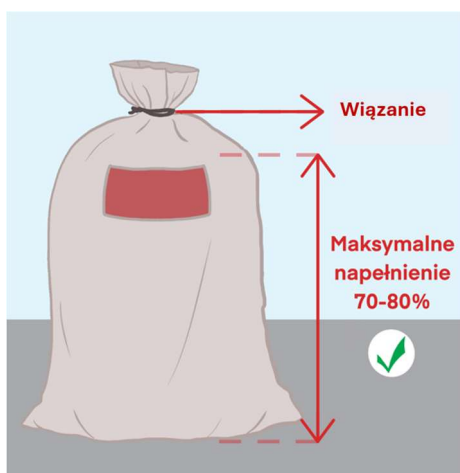
Rysunek 4 Napełnienie worków piaskiem
