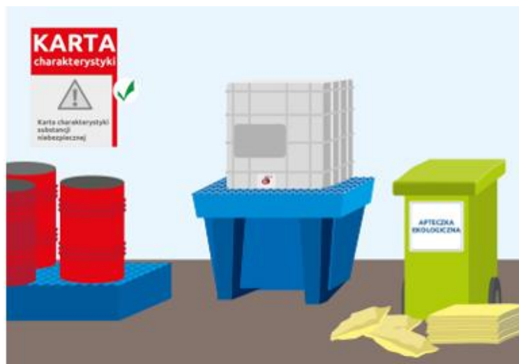
Rysunek 4 Wyposażenie miejsca prowadzenia robót w środki ochrony przed skażeniem środowiska
