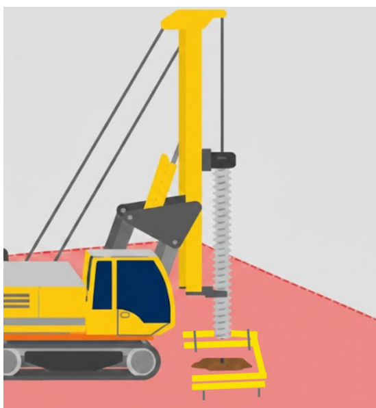
Rysunek 6 Przykładowe zabezpieczenie w układzie „U”
