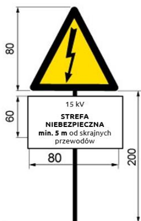
Rysunek 5 Przykład oznakowania strefy niebezpiecznej w obrębie czynnej linii elektroenergetycznej
