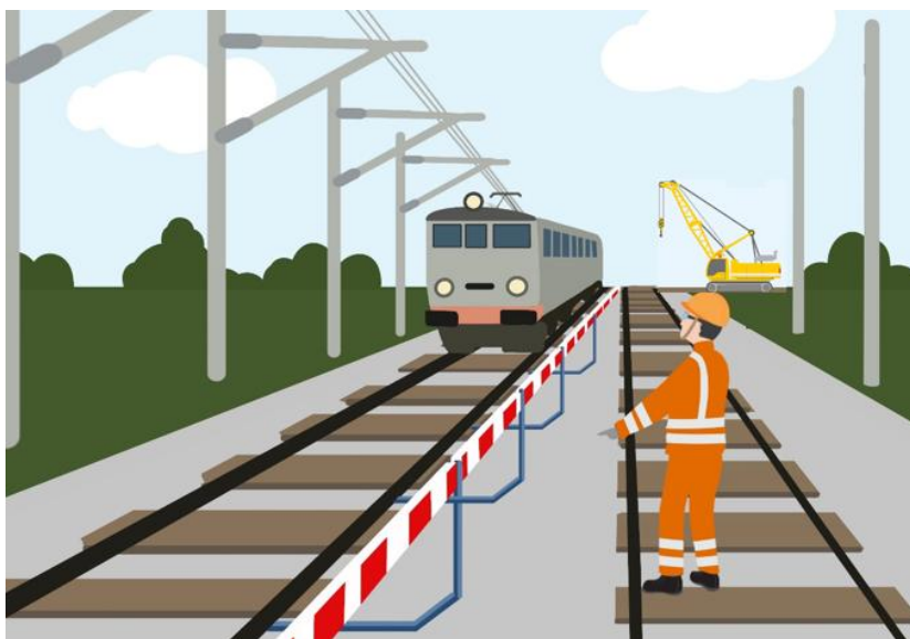
Rysunek 8 Wygrodenie strefy niebezpiecznej za pomocą bariery
