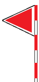
Rysunek 2 Wskaźnik oznaczający kierunek zejścia pracowników z toru
