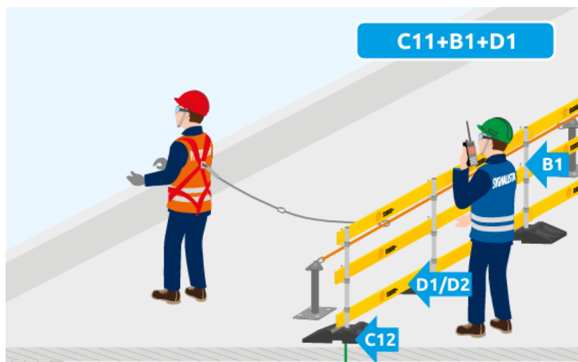
Rysunek 11 Przykładowe zastosowanie indywidualnego sprzętu ochrony przed upadkiem z wysokości
