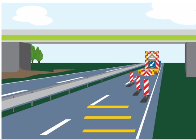
Rysunek 2 Wyznaczenie skosów jazdy za pomocą listw ostrzegawczych
