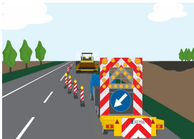
Rysunek 3 Wygradzenie jezdni wzdłuż obszaru prac wyłączonego z ruchu
