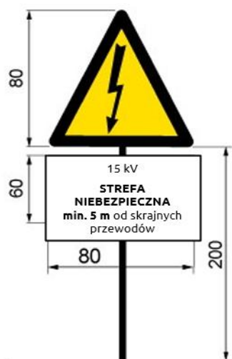
Rysunek 6 Oznakowanie strefy niebezpiecznej w obrębie czynnej linii elektroenergetycznej
