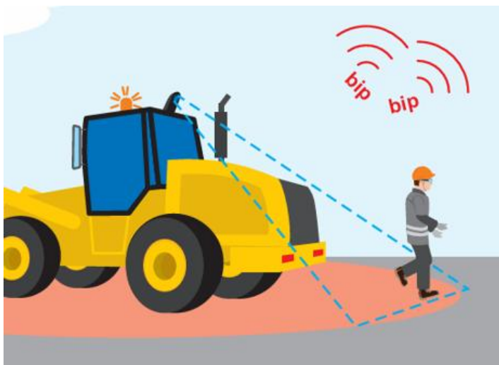
Rysunek 5 Wskazanie pól widzenia kamer, detektorów ruchu, wykrywaczy ruchu
