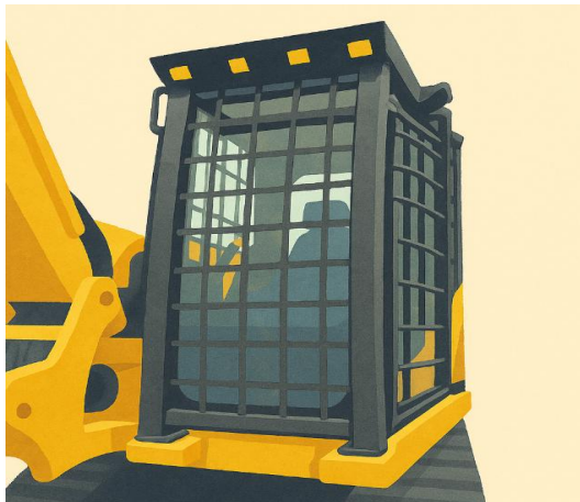
Rysunek 2 System FOPS chroniący operatora przed spadającymi przedmiotami i odłamkami
