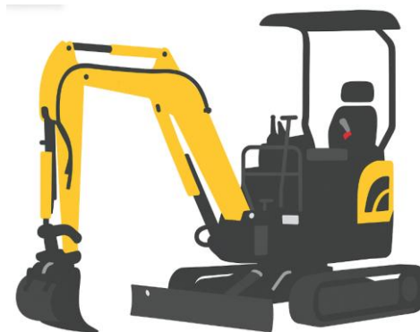
Rysunek 3 System ROPS chroniący operatora przed przygnieceniem
