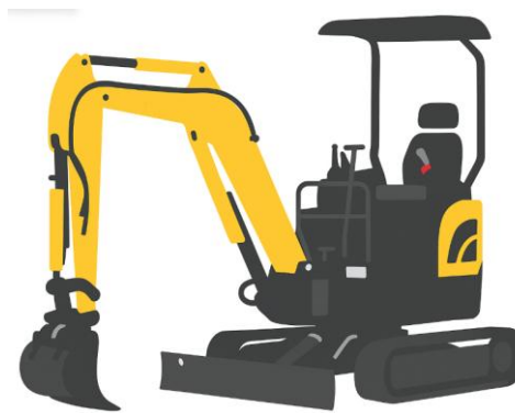
Rysunek 2 System ROPS chroniący operatora przed przygnieceniem
