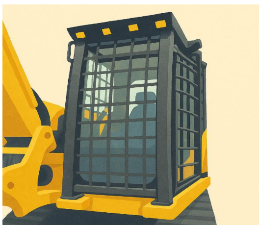
Rysunek 1 System FOPS chroniący operatora przed spadającymi przedmiotami i odłamkami
