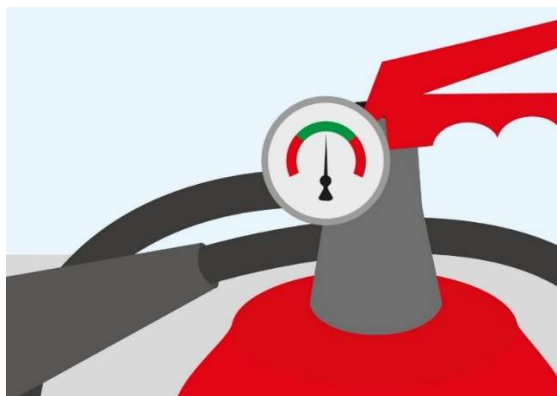
Rysunek 4 Wskazanie manometru informujące o prawidłowym ciśnieniu w gaśnicy
