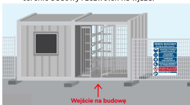
Rysunek 5 System kontroli dostępu przy wejściu na teren budowy
