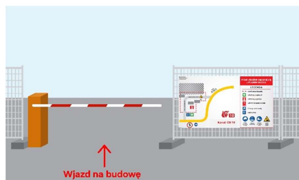
Rysunek 6 Kontrola wjazdu na teren budowy - brama wjazdowa ze szlabanem
