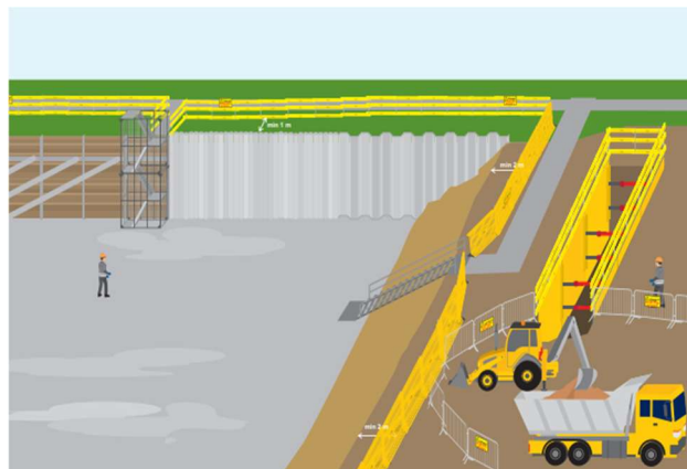
Rysunek 6 Dojścia do stanowisk pracy w wykopie
