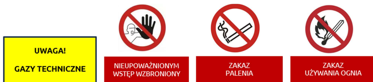
Rysunek 11 Oznakowanie miejsc magazynowania gazów technicznych
