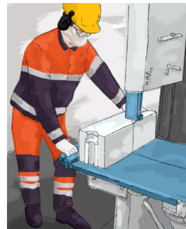
Rys. 6. Bezpieczeństwo i higiena pracy podczas piłowania cegieł
