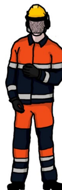
Rys. 4. Ochrona indywidualna przy pracach z pilarkami łańcuchowymi
