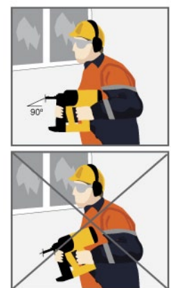
Rys. 2. Prawidłowe ustawienie osadzaka w stosunku do podłoża
