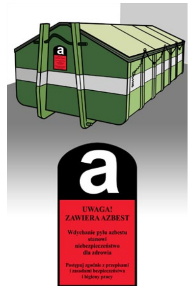
Рис. 4. Утилизация асбестосодержащих отходов
