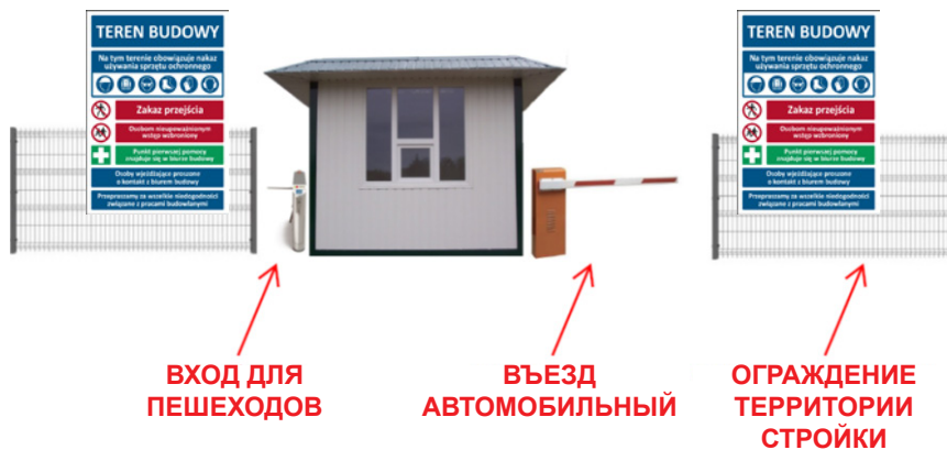
Рис. 1. Вход/выход и въезд на территорию стройки.
