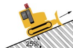
Мал. 2. Робота бульдозерів на похилих площинах під час руху вверх
