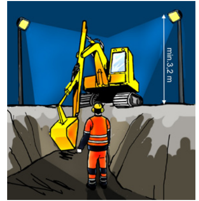
Мал. 5. Освітлення будівельного майданчика
